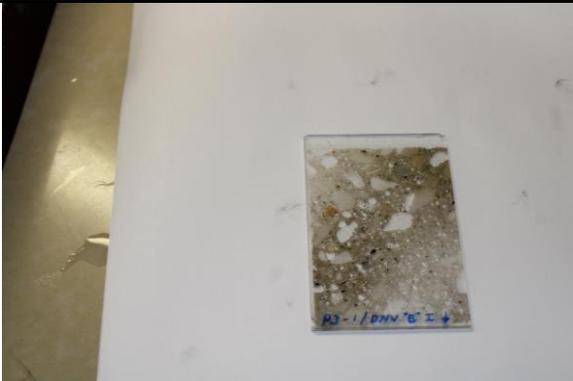
Ejemplo de muestra - Espesor ~ 30 micrones
